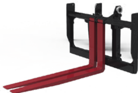
SIDESHIFT VAN QD-HAAKTYPE MET DUBBELE FUNCTIE - GELIJKTIJDIGE EN ONAFHANKELIJKE VORKENPOSITIONERING
