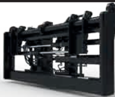
3100 mm breed vorkenbord met vorkpositionering – individuele vorkbesturing – pinttype vorken
