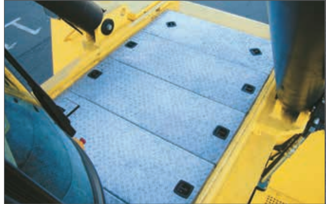
Las placas de piso de aluminio ligero permiten el desmontaje rápido para un fácil acceso de servicio
