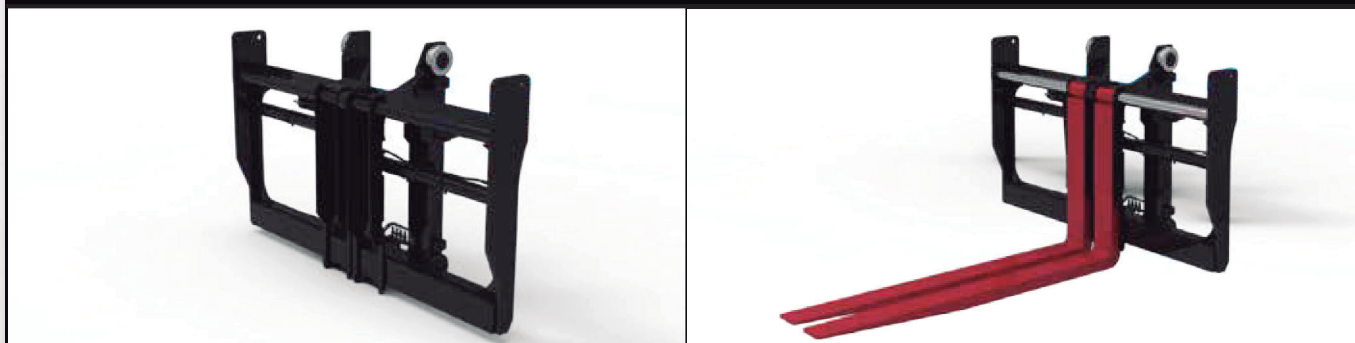
CARRO-SUPORTE TIPO PINO DE 2496MM COM POSICIONADOR DE GARFO SIMULTÂNEO E INDEPENDENTE
