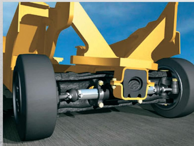
Acima: HSM™ (Mecanismo de Estabilidade Hyster) reduz a inclinação da empilhadeira em giros, aumentando a estabilidade lateral. O design possibilita um percurso superior em superfícies desniveladas.
