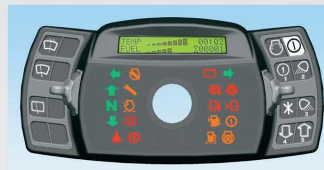
*Acima: O display de instrumento avançado integrado usa uma tela LCD não refletiva, retroiluminada e 21 luzes indicadores fornecem informações com uma passada de olho em todas as condições de iluminação.*
