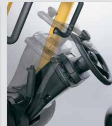
*a Esquerda: O volante de diâmetro padrão de 30 cm com manopla giratório com uma coluna de direção de inclinação infinitamente ajustável. Abaixo: A alça traseira de embarque fornece uma excelente suporte para condução em marcha ré enquanto fornece fácil acesso ao botão da buzina auxiliar.*
