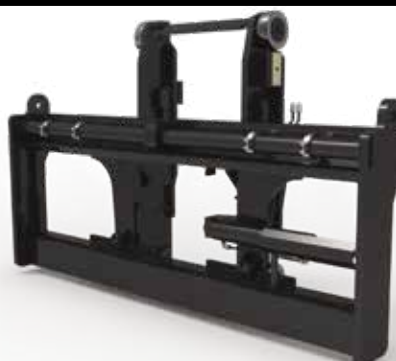
Каретка со встроенным штырем для рулонов
