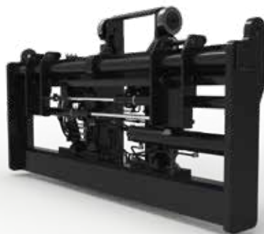
Многоцелевая двухфункциональная каретка шириной 3200 мм с крюковым креплением, механизмом бокового сдвига и позиционированием вил – раздельное управление вилами – вилы с крюковым креплением
