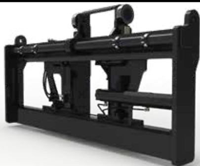
Двухфункциональная каретка шириной 3040 мм с крюковым креплением, механизмом бокового сдвига и позиционированием вил – раздельное управление вилами – вилы с крюковым креплением
