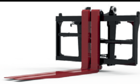
TABLIER DOUBLE FONCTION À DÉPLACEMENT LATÉRAL À CROCHET ET DÉVERROUILLAGE RAPIDE DE 2398 MM, AVEC POSITIONNEMENT DES FOURCHES SIMULTANÉ ET INDÉPENDANT
