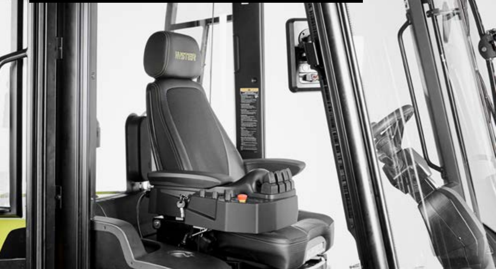
L'operatore, quando è seduto al posto di guida, ha una chiara visuale delle punte delle forche
