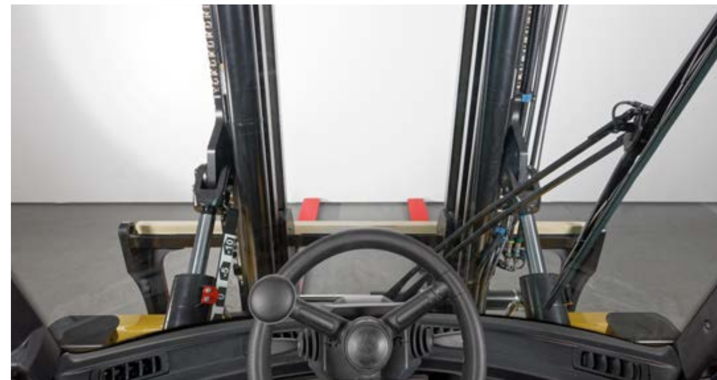
El operario tiene una visión clara de las puntas de las horquillas cuando está en el asiento del operario
