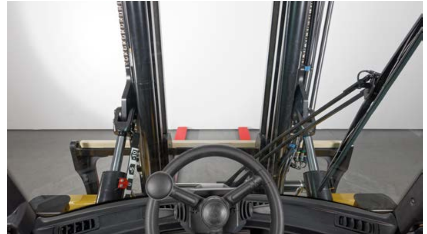
De chauffeur heeft goed zicht op de vorkpunten als hij op de bestuurdersstoel zit
