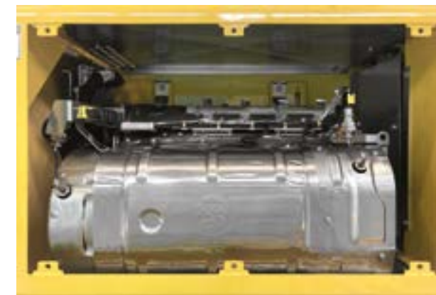
Toegang nabehandelingssysteem met ventilatie-rooster (boven), en zonder ventilatie-rooster (onder)
