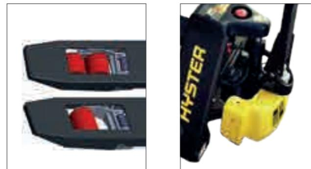
Roues porteuses simples/montées sur bogies
