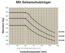
**Lastschwerpunkt:** Abstand vom Gabelrücken zum Schwerpunkt der Last. **Nennlast:** Basiert auf vertikalen Hubgerüsten bis 4.600 mm bis Oberkante der Gabeln.
