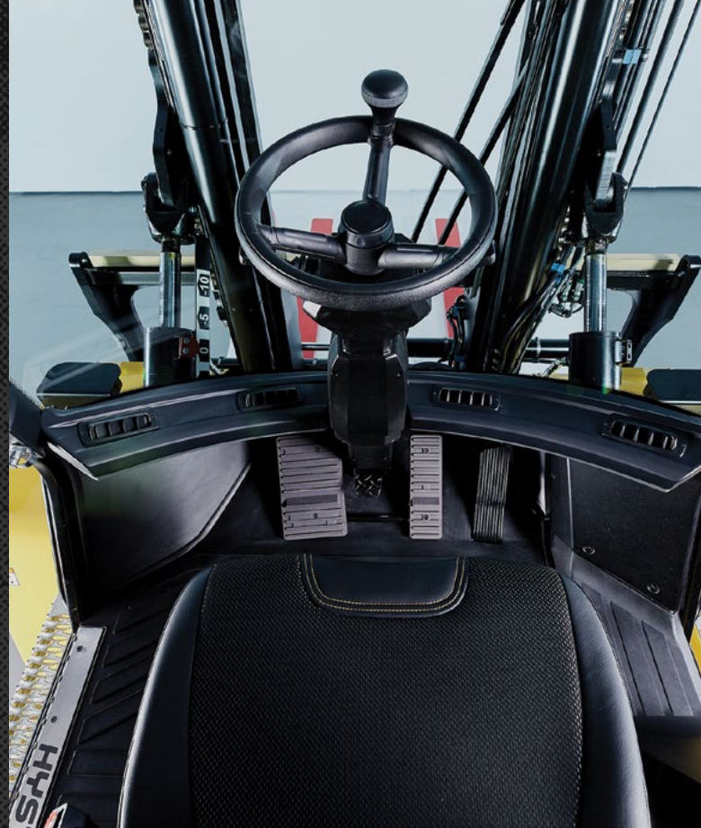
Der Fahrer hat auf dem Fahrersitz freie Sicht auf die Gabelzinkenspitzen.
