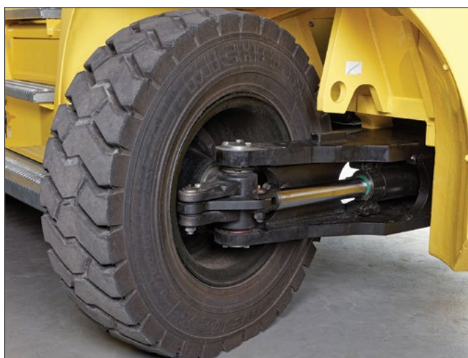
Angle de direction maximum réglable
