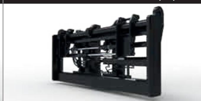
Piastra porta-forche standard larga 3.100 mm con posizionatore forche – Comando forca individuale – Forche di tipo a perno
