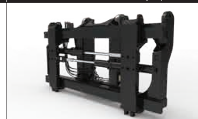
Piastra porta-forche multifunzione a doppia funzione larga 3.200 mm con traslatore laterale e posizionatore forche – Comando forca individuale – Forche di tipo a gancio
