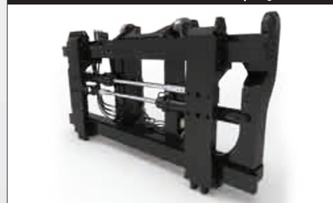
Piastra porta-forche a doppia funzione di tipo a gancio larga 3.040 mm con traslatore laterale e posizionatore forche – Comando forca individuale – Forche di tipo a gancio
