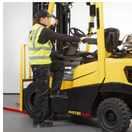
Facilità di accesso, il gradino ribassato riduce l'affaticamento dell'operatore aumentandone la produttività.
