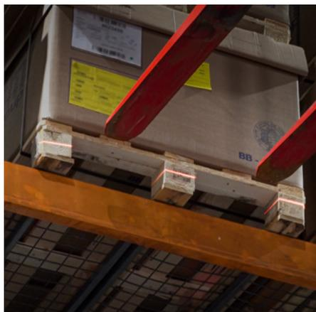
Dotazioni e funzionalità avanzate, quali la funzione anti-allentamento catene, la linea laser di posizionamento forche e l'indicatore di peso del carico **aumentano i livelli di produttività e contribuiscono a ridurre i danni ai prodotti**
