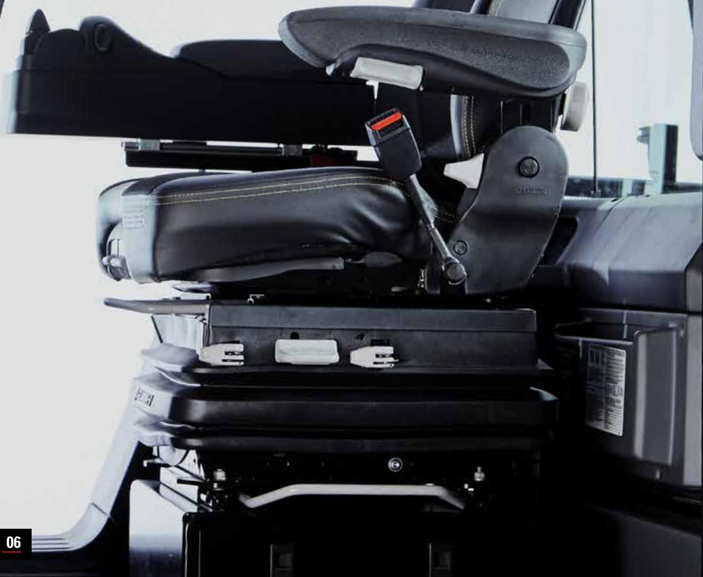
Los operarios pueden mantenerse conectados y con carga con hasta 2 Puertos USB situados en el brazo de control y detrás del asiento con una toma de alimentación CA/CC.
