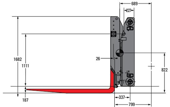
**Hakengeführter zwei Funktionsgabelträger mit Seitenschub und Gabelzinkenverstellung**
