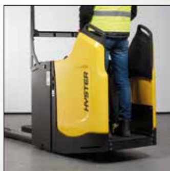
PROTECTIONS LATÉRALES FIXES AVEC ACCÈS PAR L'ARRIÈRE
