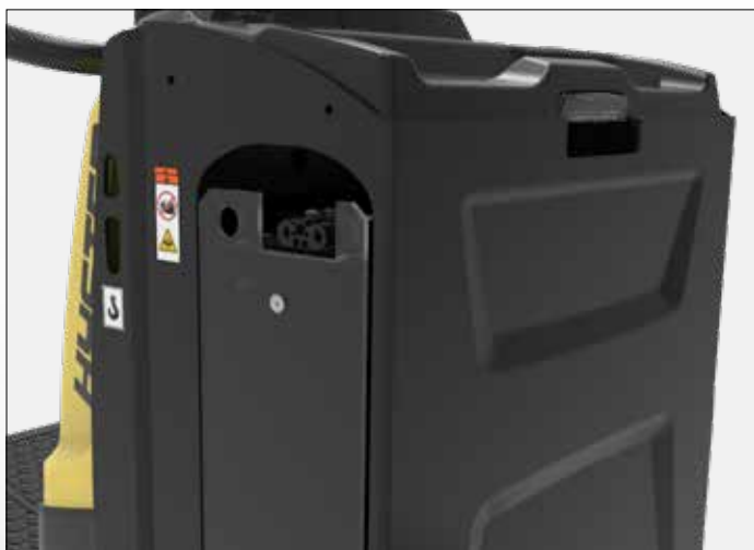
MISE EN CHARGE PAR LE CÔTÉ DE LA BATTERIE LITHIUM-ION
