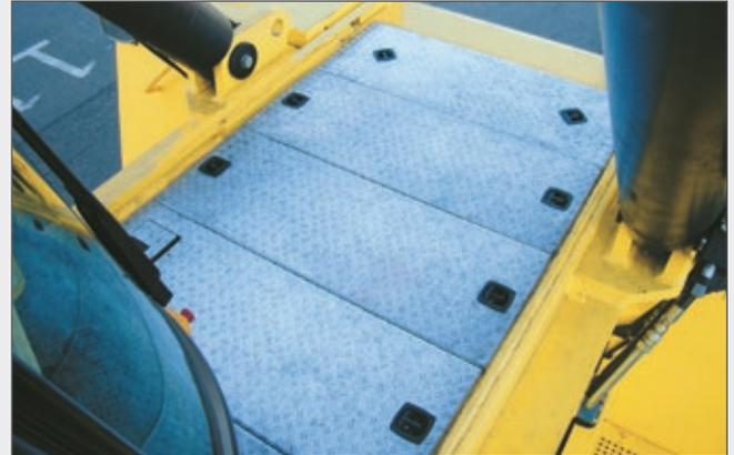
Las placas de piso de aluminio ligero permiten el desmontaje rápido para un fácil acceso de servicio
