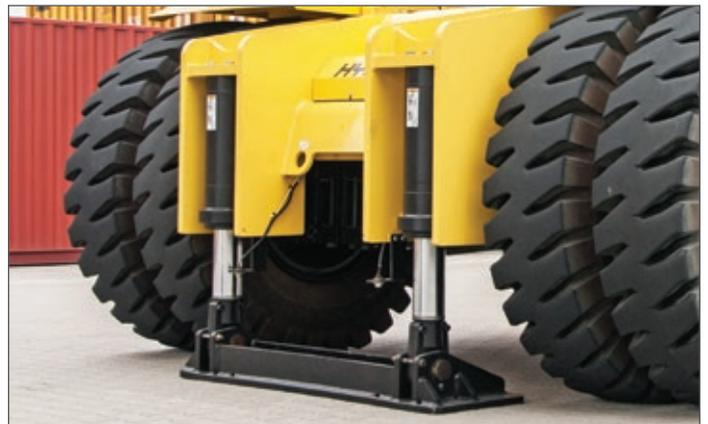
El innovador estabilizador de alta resistencia se despliega rápidamente, aumenta la estabilidad lateral y reduce el desgaste de los neumáticos en el eje trasero.
