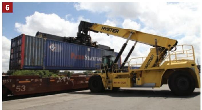
Un ReachStacker de Hyster puede equiparse con un accesorio de cambio de herramientas que permite al operario cambiar más fácil y rápidamente entre diferentes herramientas y permite una flotilla más eficiente y productiva para las operaciones siderúrgicas.
