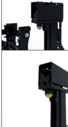
Spreader de contenedor de manipulación individual con cierres por torsión verticales
