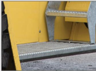
*Estribos anchos y resistentes al deslizamiento*
