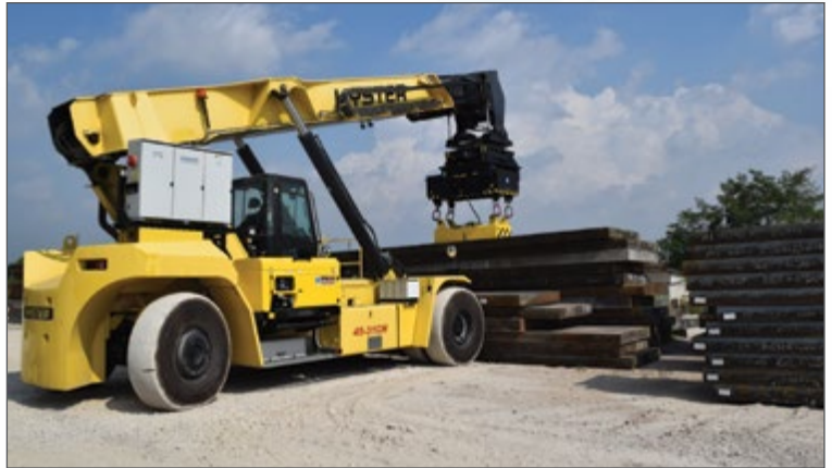
La versatilidad es clave en la Serie RS46. Se muestra el aditamento magnético para el manejo de placas de acero.
