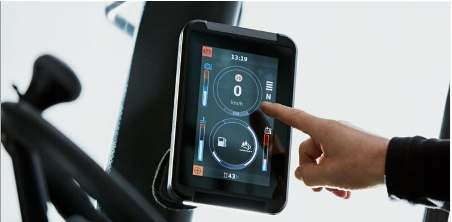
*Una pantalla de rendimiento integrado a todo color de 7 pulgadas proporciona los datos de rendimiento del montacargas en una sola pantalla despejada.*
