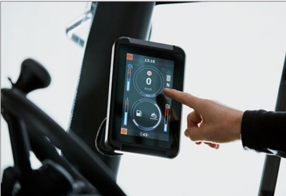
*Una pantalla de rendimiento integrado a todo color de 7 pulgadas proporciona los datos de rendimiento del montacargas en una sola pantalla despejada.*
