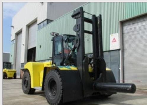
*Hyster también ofrece un mástil de elevación directa construido con un diseño de canal único y un cilindro para bobinas integral en forma de U conectada directamente a los cilindros de elevación. Este robusto diseño carece de cadenas de elevación y ofrece una visibilidad ideal, resistencia al calor y durabilidad en aplicaciones de manejo de bobinas.*
