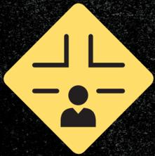
Los peatones deben **estar atentos a las obstrucciones visuales** en las intersecciones y deberán mirar los espejos de cúpula de 360° por encima de la cabeza o los espejos convexos para ver si hay tráfico de montacargas industriales motorizados antes de avanzar.
